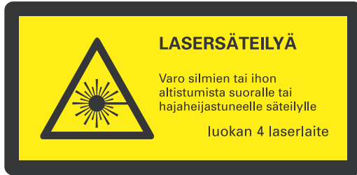
Kuva 3.14 Esimerkkejä kilvistä, joissa on lasersäteilyn varoitusmerkki ja turvallisuusluokan mukainen varoitusteksti
